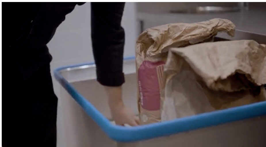
Chariot à fond variable : le fond s'adapte au poids des sacs de farine, qui ne sont donc plus « au fond » et demeurent à portée de main dans le chariot.
